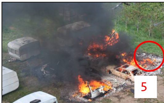
Nabovogner er utbrende. Raud sirkel viser kor brannen starta. Tid: 25 min.
