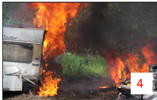
Avstand på 3 m mellom vognene. Nabovogna blir antent pga strålevarmen frå den overtente vognna. Tid: 20 min.
