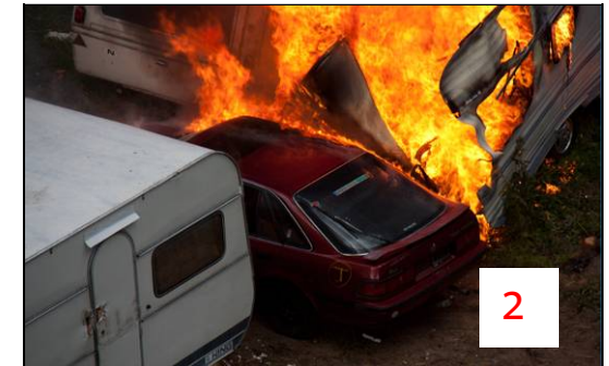
Bilens lakk blir påtent. Tid: 4 min og 43 sek.
