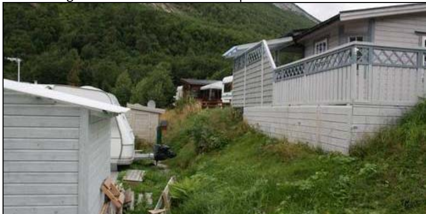
Horisontalavstand mellom faste konstruksjonar må vere minst 8 m – i dette høvet her er truleg for liten avstand. Foto frå Jemtegård. Sjå prinsippkisse nedanfor.
